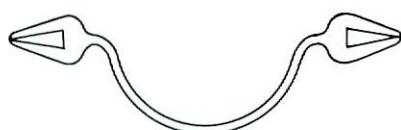
この目地材は平滑に平行伸縮を行い、中央部を踏み込んだ時力は両方の肩の部分に分散して受け止め、上からの踏圧には強く反撥し踏面が落込まない様になっており又水平方向には軟かく対応出来る様な構造となっております。
